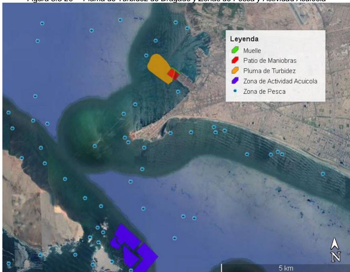
Figura 8.5-20 Pluma de Turbidez de Dragado y Zonas de Pesca y Actividad Acuícola
