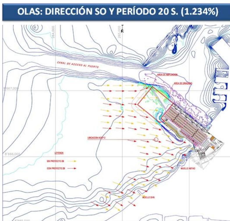
Figura 7-12: Resultado del modelo STWAVE para D= ONO y T= 20 s. Resumen de direcciones con y sin proyecto, se evidencia que no hay modificación del patrón de oleaje sobre la costa.
