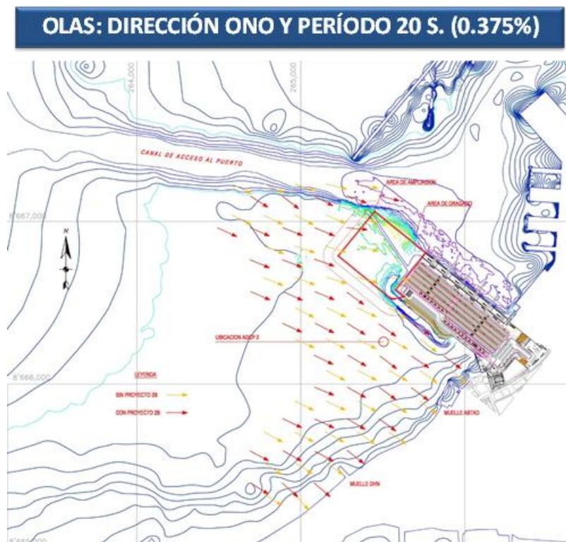
Figura 7-16: Resultado del modelo STWAVE para Procedencia ONO y período 20 s. Resumen de direcciones con y sin proyecto, se evidencia que no hay modificación del patrón de oleaje sobre la costa.
