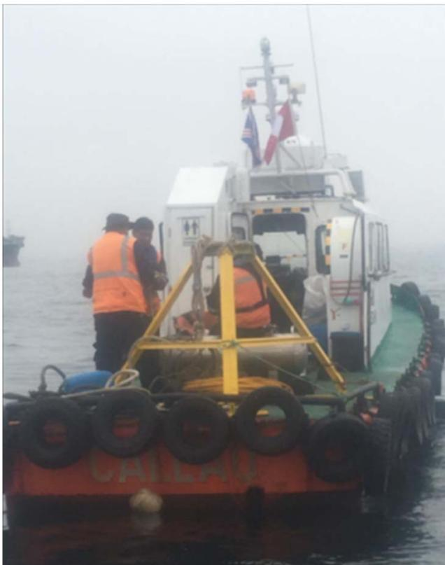
Embarcación y soporte metálico para instalación de ADCP en fondo fangoso.
