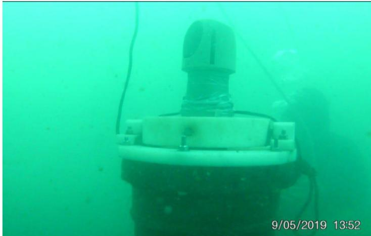
Imágenes submarinas del equipo instalado en el tubo de PVC.
