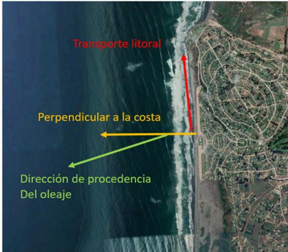
**Figura 8-1: Esquema del transporte litoral.**
